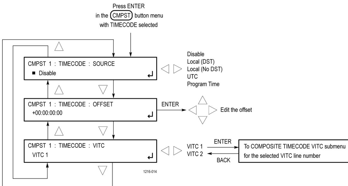
**Figure 71: COMPOSITE TIMECODE submenu diagram**
